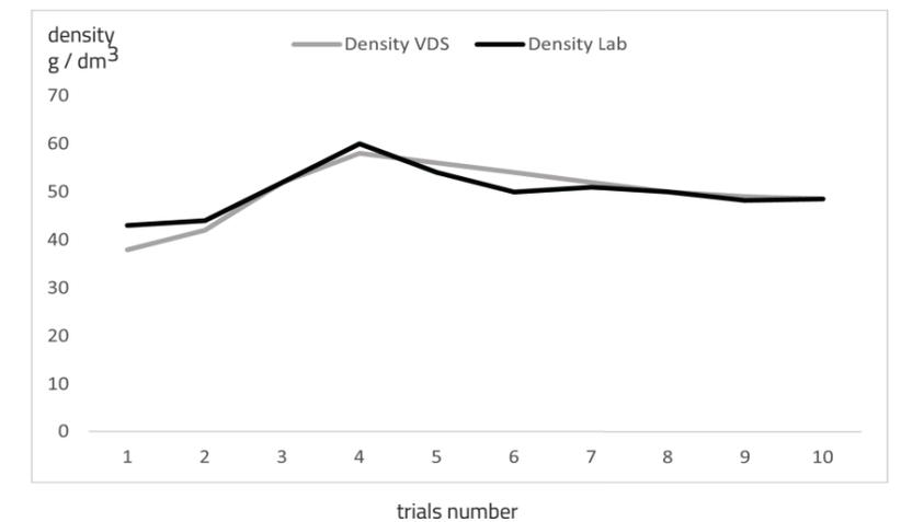
Die gängigen Systeme zur volumetrischen Dosierung zeigen in der Regel signifikante Abweichungen zu den Laborwerten aus der Qualitätssicherung.
