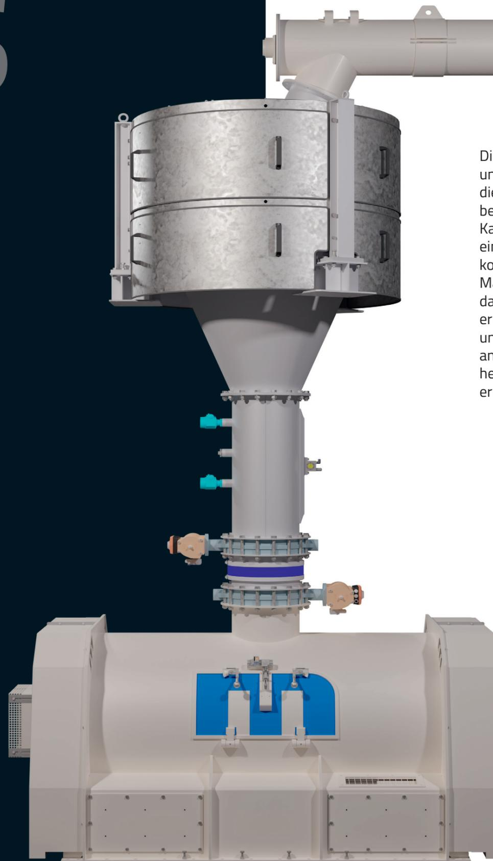
Die Waage wird tariert und dann beginnt die Schüttgewichtsbestimmung im Kalibriermodus in einem langsamen, konstanten Materialfluss. Ist das Schüttgewicht ermittelt, schaltet der Prozess in den eigentlichen Dosiermodus und füllt das gewünschte Volumen in den Waagenbehälter. Dies geschieht anfangs mit hohem Materialfluss, welcher kurz vor Erreichen des Sollwerts heruntergeregelt wird. So kann die maximale Präzision des Dosiervorgangs erreicht werden.
